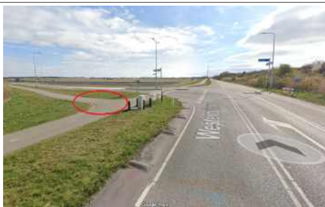
Voorrang voor fietsers N502-N503 is hier niet geregeld. Voorstel: N503 in de voorrang – FB#6
